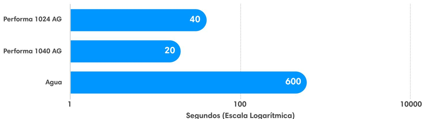
Estos resultados muestran cuán dramáticamente se mejora la penetración del suelo, al usar surfactantes biodegradables. La escala logarítmica tuvo que ser utilizada para representar la penetración del agua (Control), debido a la gran diferencia en **Performance**®.
