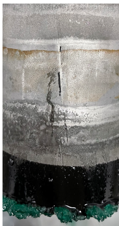
Ácido sulfúrico tratado con 316-SS durante 2 semanas
